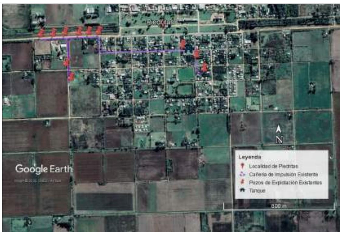
**Figura 2: Ubicación de la cañería, pozos existentes y tanque de almacenamiento.**
