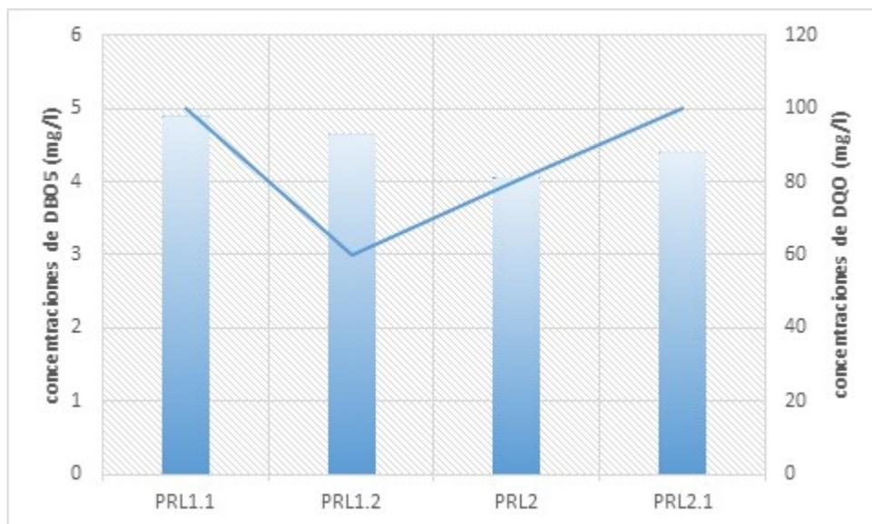
*Figura 44 - Concentraciones de DBO<sub>5</sub> (mg/l) y la línea muestra las concentraciones de DQO (mg/l) halladas en los 4 sitios que pertenecen al día 19/02/2020*
