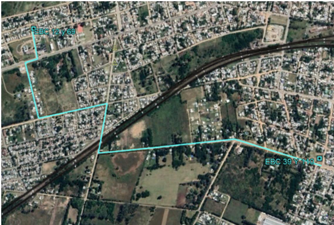
*Figura 5- Impulsión y estación de bombeo en la ciudad de Mercedes.*
