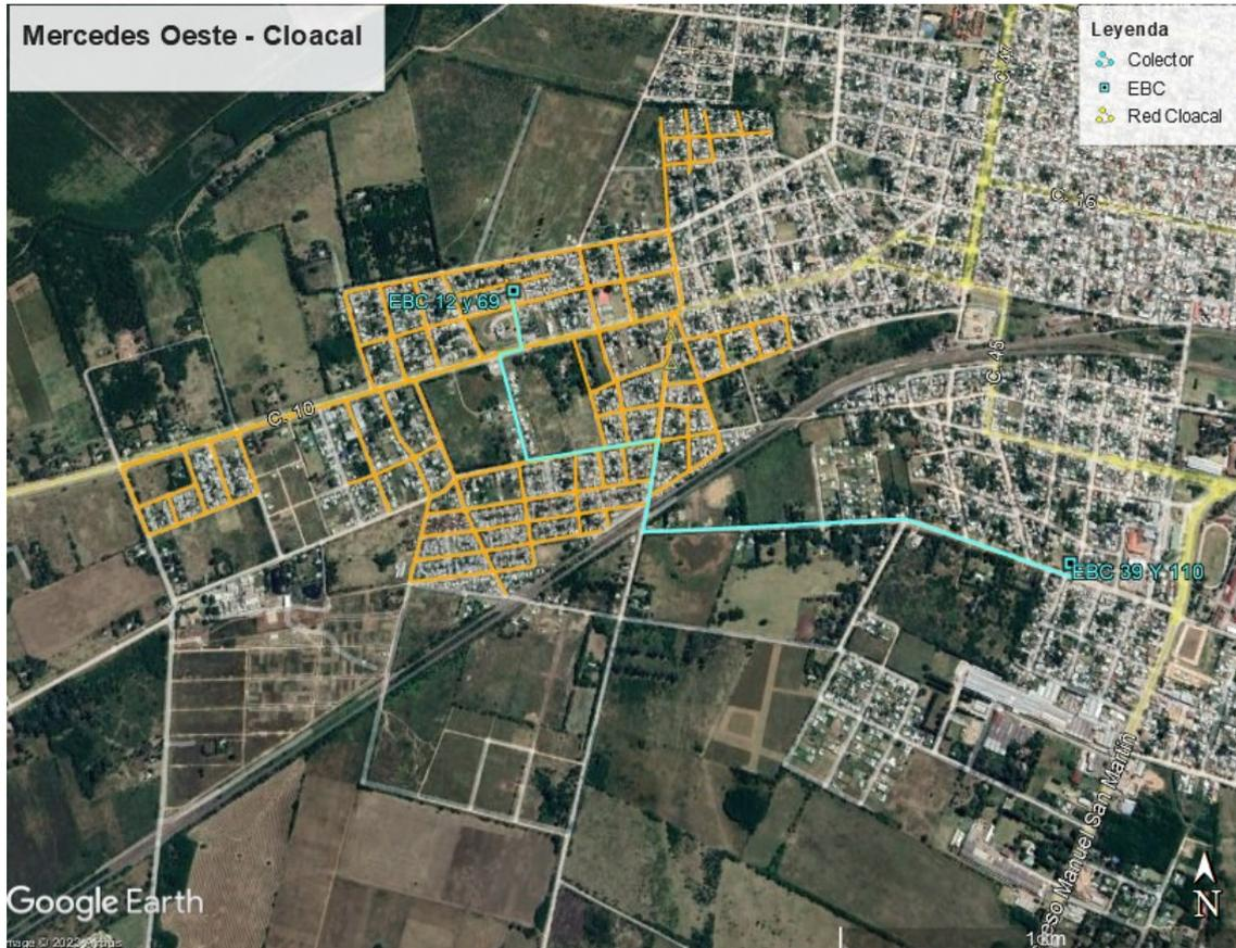
*Figura 6 – Distribución de red cloacal a expandir – Estación de Bombeo y cañería de Impulsión*
