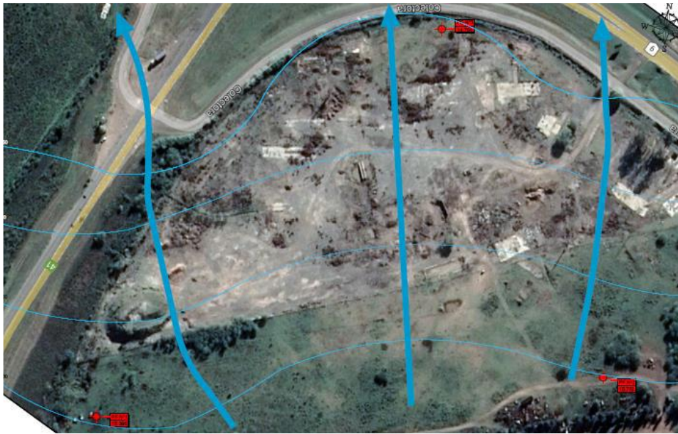
Figura: Imagen satelital con la ubicación de los pozos freático y mapa equipotencial.
