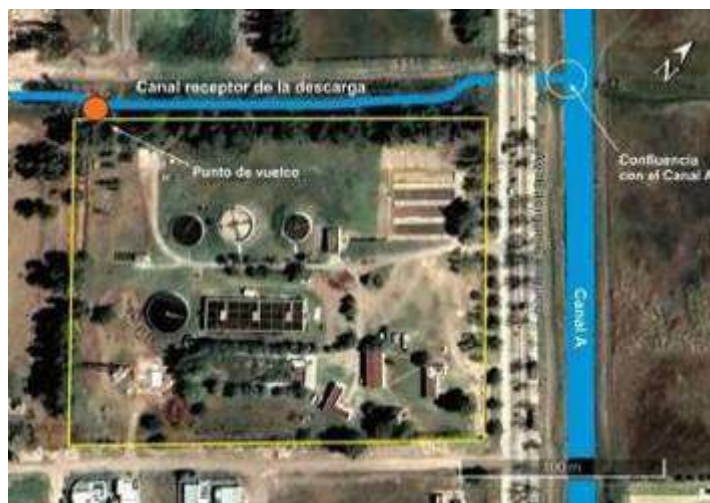
Figura 6. Punto de vuelco de la actual PTAR.
