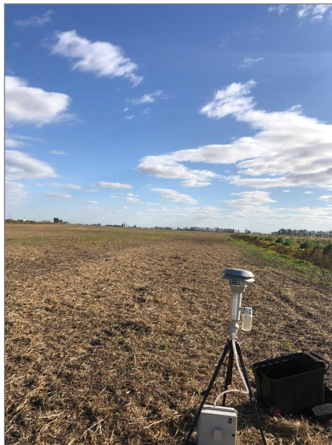
Ilustración 9: Equipo de medición de calidad de aire en campo. Fuente: Biogroup.
