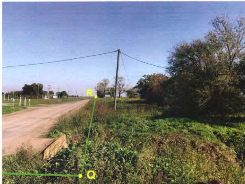
Foto 15: Una vez cruzada la calle Malvinas Argentinas, llegado al Punto Q, la traza gira unos 90° hacia el oeste, desarrollándose por el préstamo de la calle, hasta llegar al Punto R, ubicado sobre la calle Miryam Stefford, donde gira 90° aprox. hacia el norte, conforme se visualiza en la foto de dron que sigue
