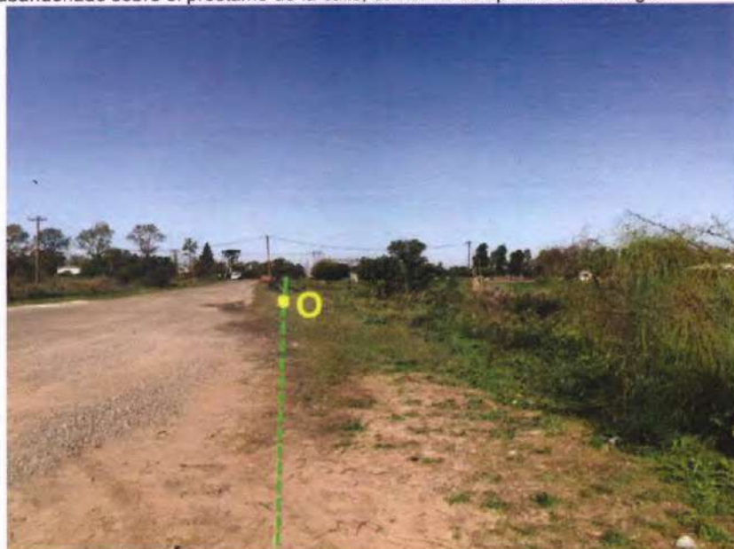
Foto 8: tomada a unos 6 metros de la cabecera este del puente sobre el Río Ramallo, sobre el préstamo de la calle Tierra del Fuego, observando hacia la posición de la ET RAMALLO, que se advierte al fondo de la imagen, con la visualización de una torre reticulada de 500 kV. El Punto O, posicionado a unos 90 metros de la cabecera del puente, es el punto donde se ejecutará la cámara de ataque, para pasar con el CAS bajo el lecho del río, permitiendo un avance de la profundización del tuneleo con una pendiente del 10%.
