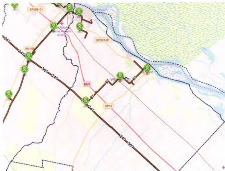
Figura 3.34. Vista del tendido de gasoductos troncales y estaciones reguladoras en el partido de Ramallo y San Nicolás.
