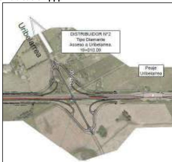
Ilustración 16: Ubicación de intercambiador de Acceso a Uribelarrea según planimetrías de proyecto, coincidentes con ubicación ppp
