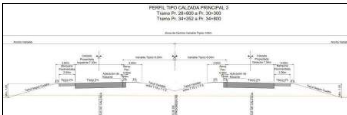
Figura N° 3: Perfil Tipo Calzada Principal Transición Peaje
