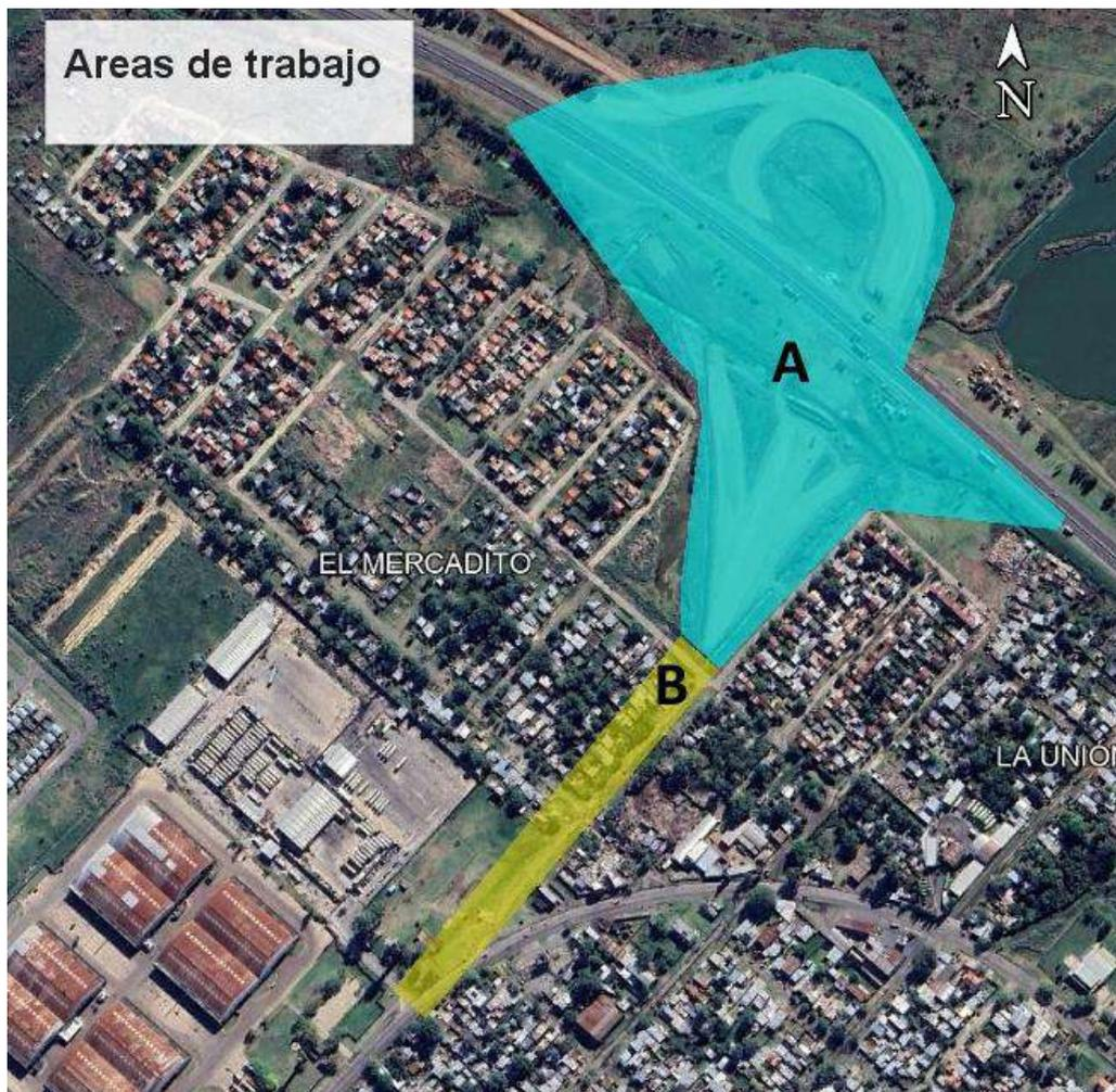
Para el área A la obra consiste en la construcción de la obra básica y obras de arte menores, que incluye la ejecución de trabajos de movimiento de suelos y sub bases de suelo del distribuidor en las ramas de entrada y salida de la Autopista y la construcción de alcantarillas.
