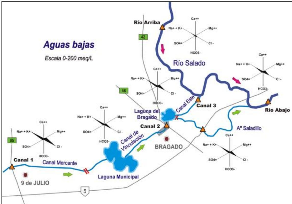
Figura 19: Sistema de canales que drenan los excesos hídricos hacia el Río Salado. Se muestran datos químicos del agua superficial bajo diferentes regímenes hídricos.
