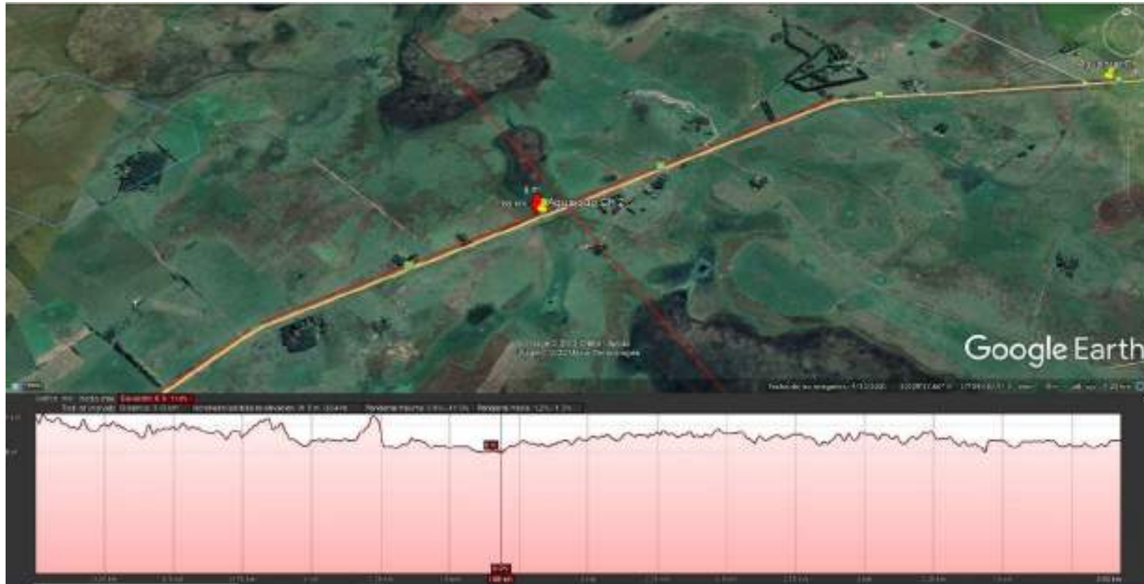
Imagen 23. Perfil de elevación de transecta paralela a la ruta N° 20 a la altura de la alcantarilla hacia la laguna Las Margaritas.
