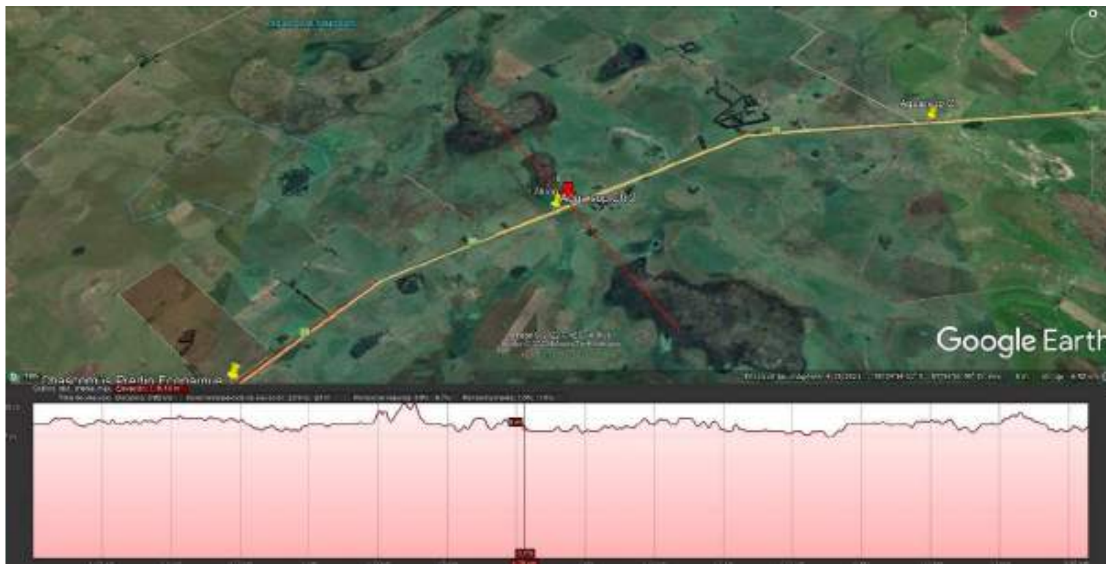
Imagen 22. Perfil de elevación de transecta perpendicular a la ruta N° 20 a la altura de la alcantarilla hacia la laguna Las Margaritas.
