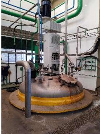
*Figura. Vista superior de uno de los reactores de polimerización.*
