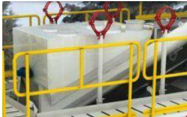
Fotografía 3. Dosificador de cemento.
