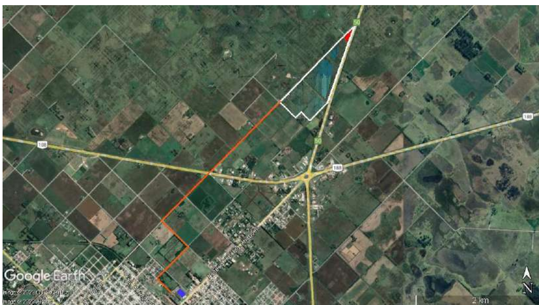
Imagen 3. Trazado de la LMT de vinculación (línea roja). Fuente. Google Earth/ GENNEIA S.A.
