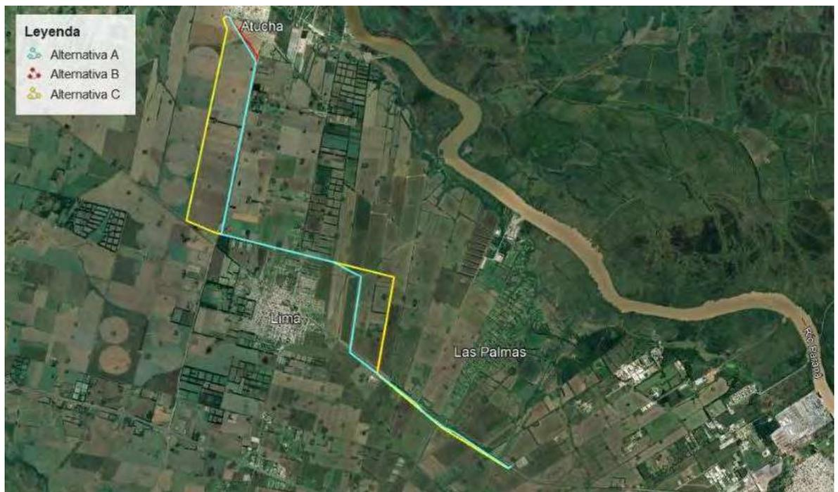
Figura 2-4. Alternativas de trazas para la futura LAT 132 kV CAREM25 - LAS PALMAS (LPN).
