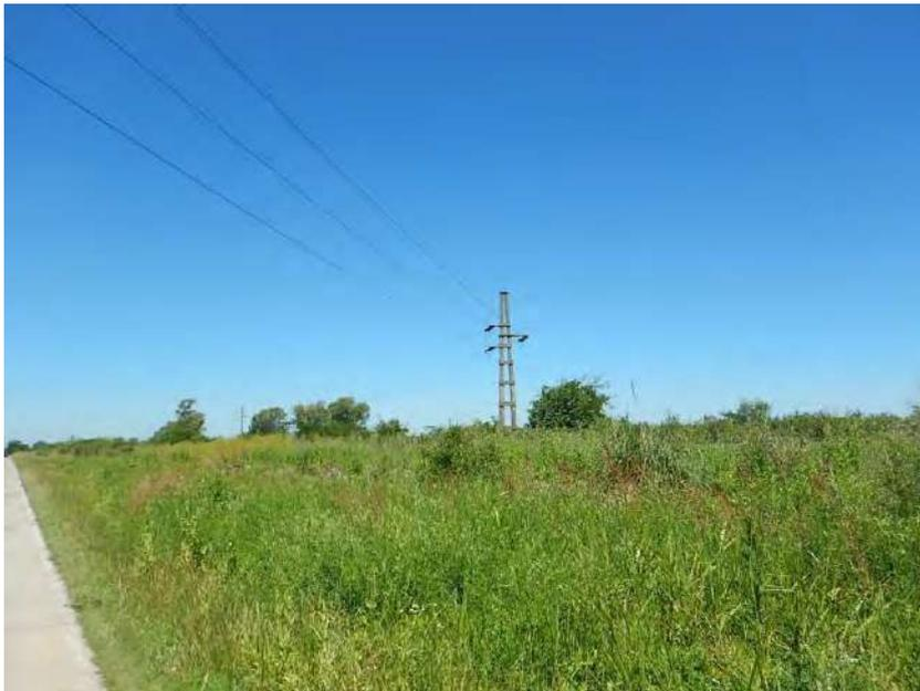
Foto 2-10. Vista a estructura de retención 31E existente. Punto de conexión de la LAT 132 kV Atucha-Zárate (1ATZA1) existente, con la terna que viene del lado del camino provincial.
