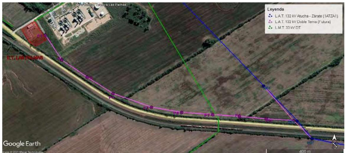
Figura 2-2. Apertura de la LAT 132 kV Atucha-Zárate y nueva LAT 132kV Doble Terna a ET LAS PALMAS 132/33kV.
