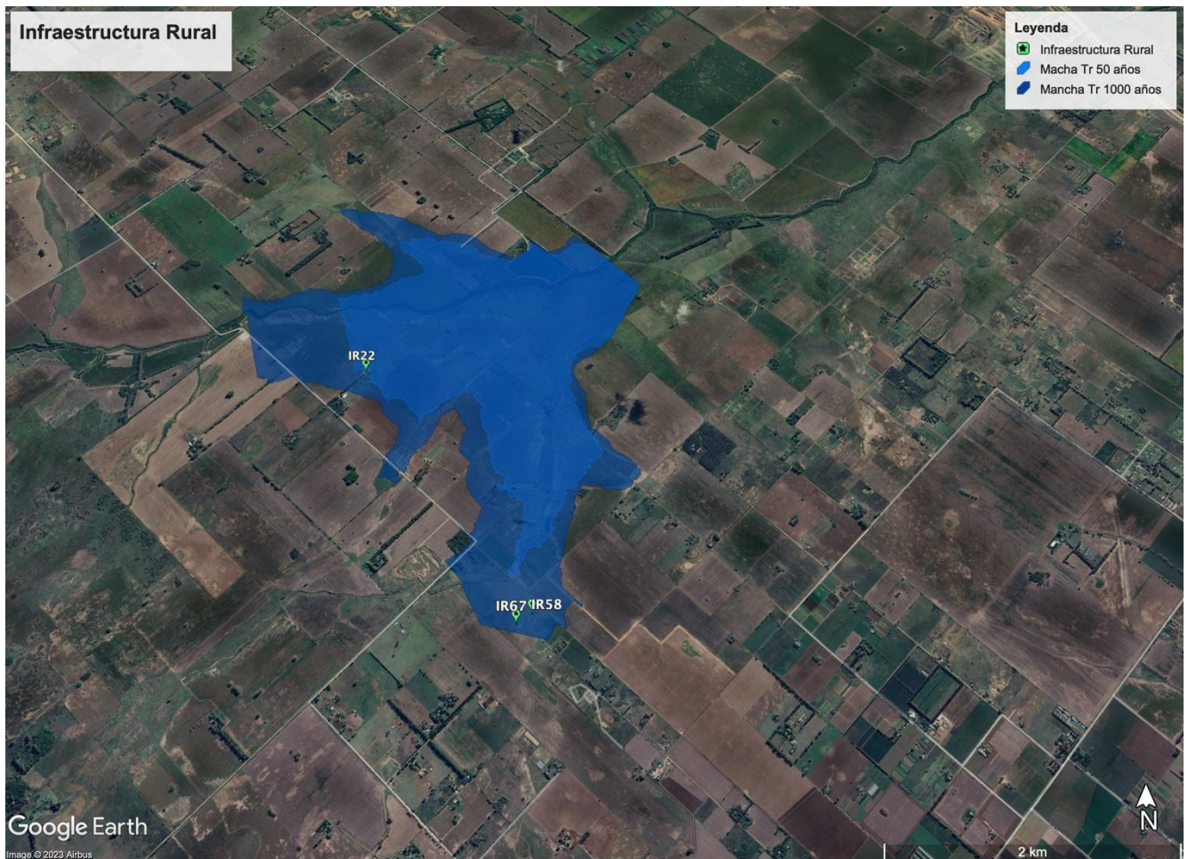
Figura 2-5. Afectación sobre infraestructura rural – Manchas 50 y 1000 de tiempos de recurrencia.
