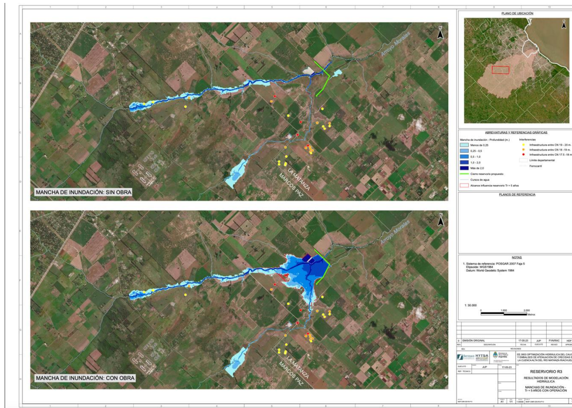
Figura 3-18 Manchas de inundación con una recurrencia de 5 años de recurrencia. Las tonalidades de azul denotan la profundidad: de más claro (menos profundo) a más oscuro (más profundo).
