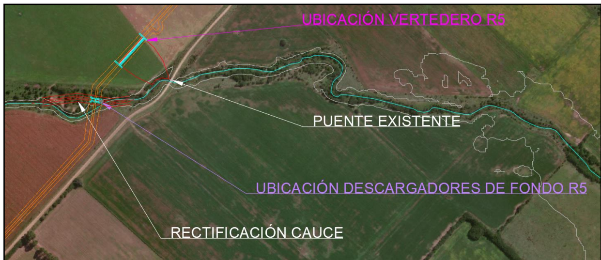
Figura 2-1. Reservoir R5 – Planimetría de Obras.
