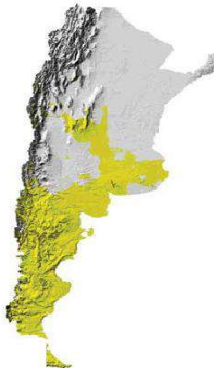
Figura 2. Factor de Capacidad >35% a 70m de altura.
