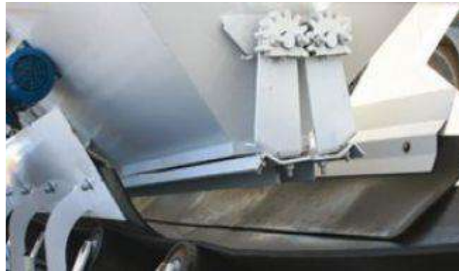
Fotografía 3. Dosificador de agregados
