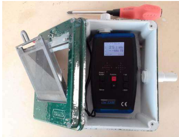
Fotografía 37. Equipo detector de ultrasonido utilizado en la estación fija de escucha.
