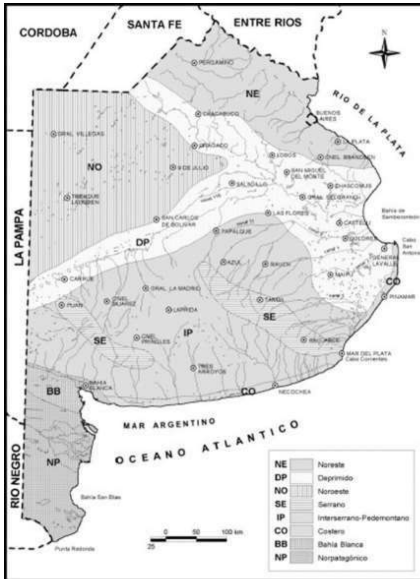
Figura 34. Mapa de las regiones hidrogeológicas de la Provincia de Buenos Aires. Fuente: Regiones Hidrogeológicas República Argentina y Provincias de Buenos Aires, Mendoza y Santa Fe (Auge, 2004).
