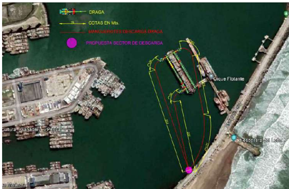
Fig. 1.7: Areas de dragado-descarga y disposición de mangueras
