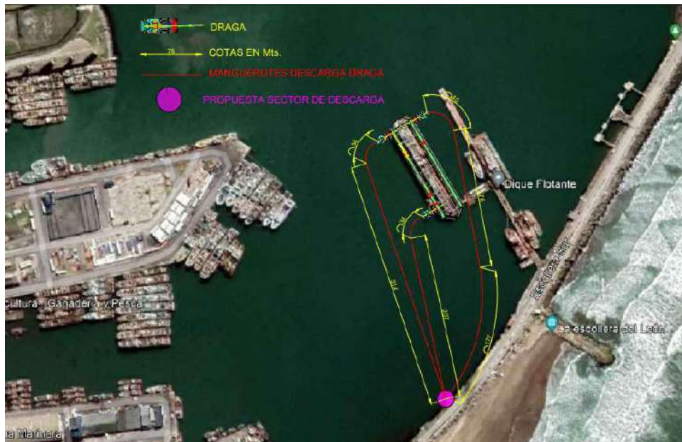
Fig. 1.7: Areas de dragado-descarga y disposición de mangueras
