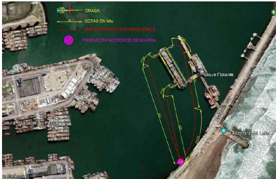
Fig. 5: Areas de dragado-descarga y disposición de mangueras
