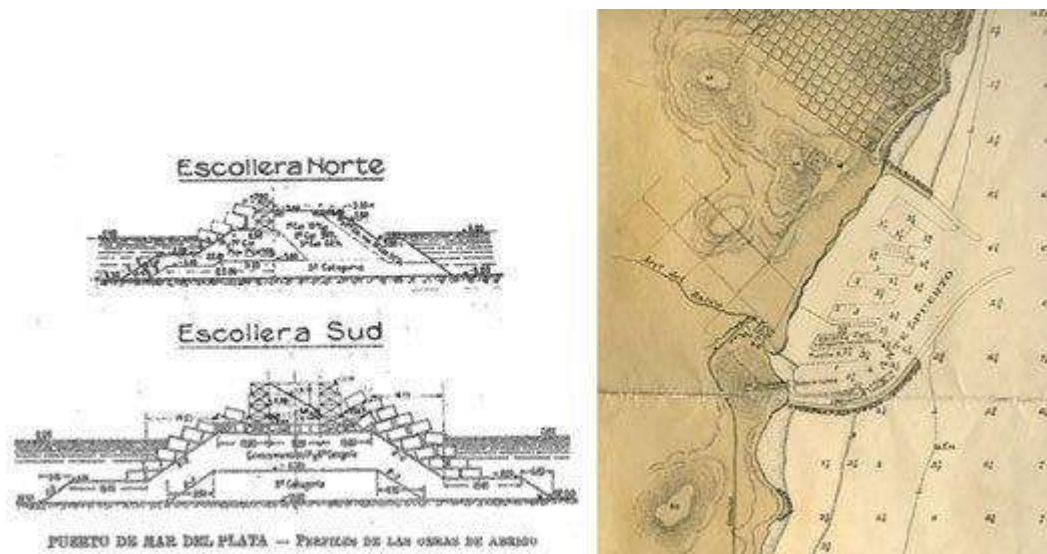
Fig. 2. Perfiles de diseño de las esolleras norte y sur. Evolución de la construcción de ambas esolleras según carta de 1915.
