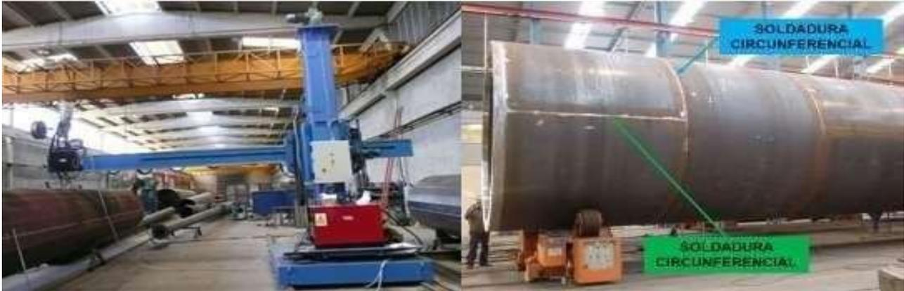
Imágenes de la operación de soldadura por arco sumergido y los 2 tipos de uniones presentes.
