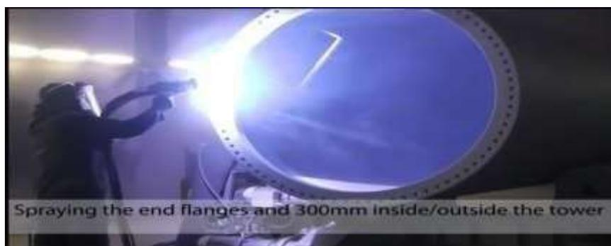
Imagen de un proceso de metalizado.
