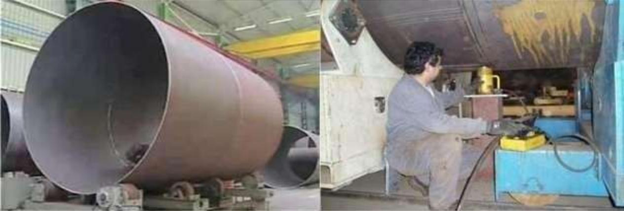
Conjunto estructural formado por dos virolas montadas sobre los viradores/
