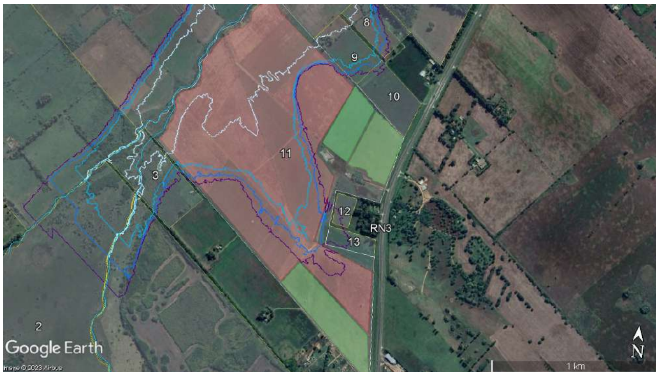
Figura 3-27. Áreas destinadas a la agricultura dentro de parcela 11. En rojo: áreas afectadas por Tr 1000 años; en verde: áreas no afectadas.
