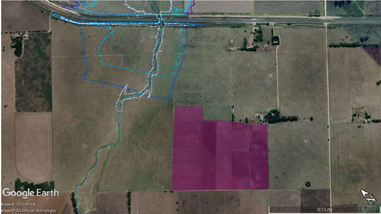
Figura 2-44. Interacción entre la mancha de inundación Tr. 2, 50 y 200 años y la zona destinada a la agricultura dentro de la parcela 9 (en violeta). Fuente: Google Earth.
