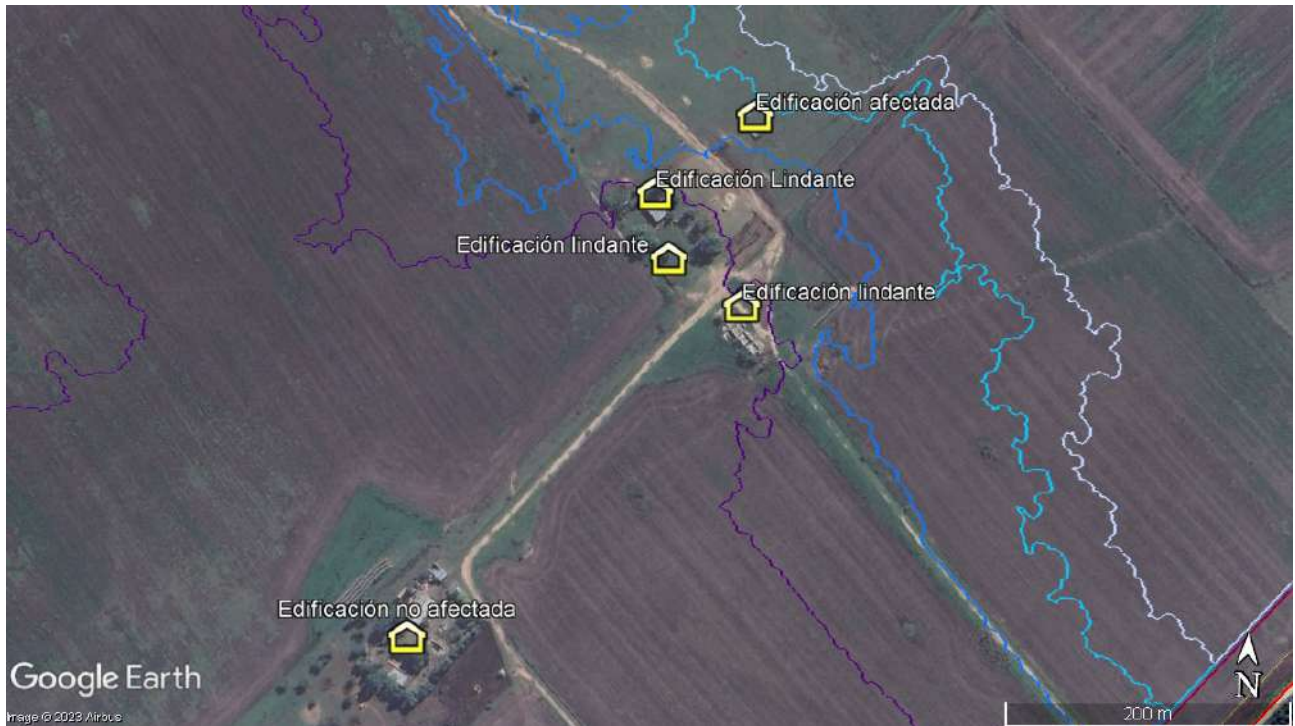
Figura 3-21. Edificaciones afectadas en Parcela 7, según mancha Tr. 2, 50, 200 y 1000 años. Fuente: elaboración propia en base a Google Earth.
