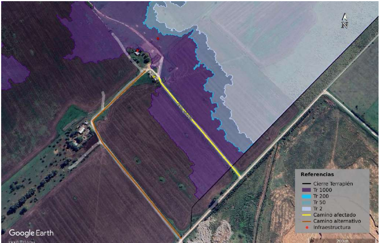
Figura 2-25. Afectación de camino privado por la ejecución del terraplén, parcela ID 7.
