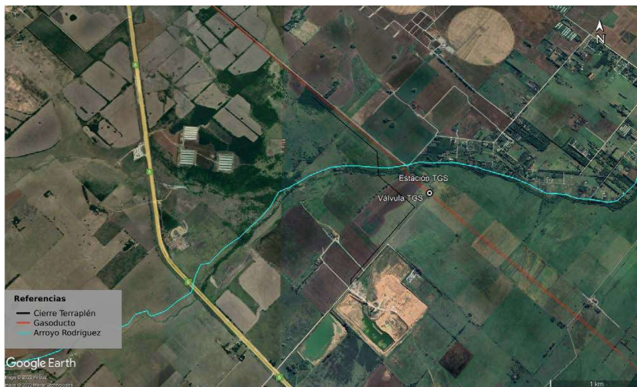
Figura 3-31. Traza del gasoducto, estación y válvula.
