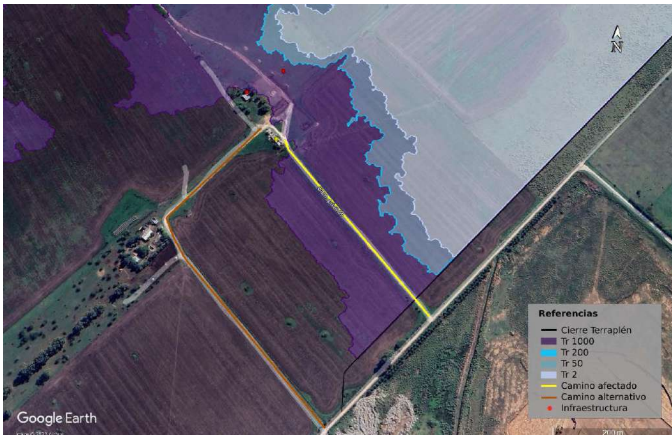
Figura 3-22. Afectación de camino privado por la ejecución del terraplén, parcela ID 7.
