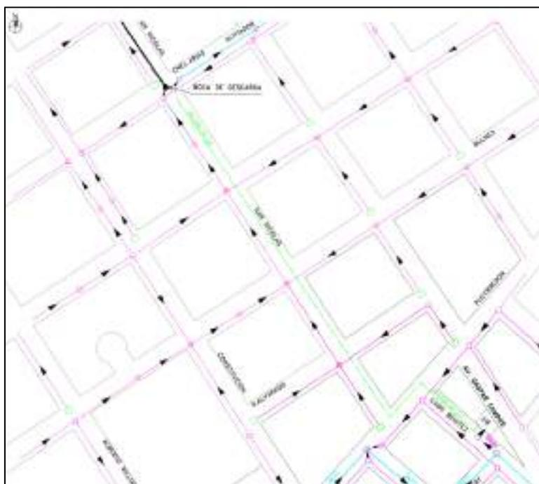
**Figura 3 Tramo de cañería de impulsión proyectada (en verde)**
