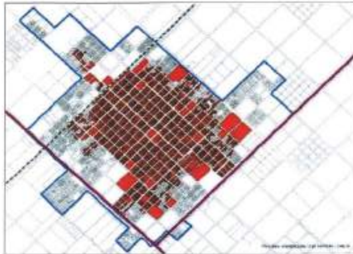
Figura 23. Parcelas abastecidas con servicio de cloaca.
