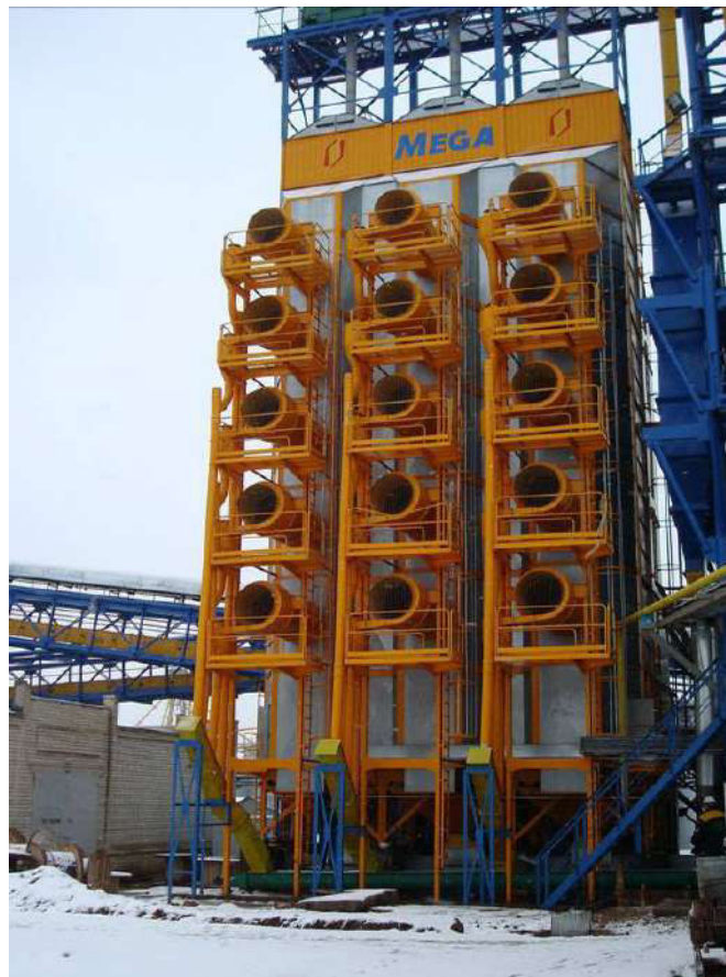
MEGA TC 420 con Separadores de Polvo. MEGA TC 420 with Dust and Fine Collectors.
