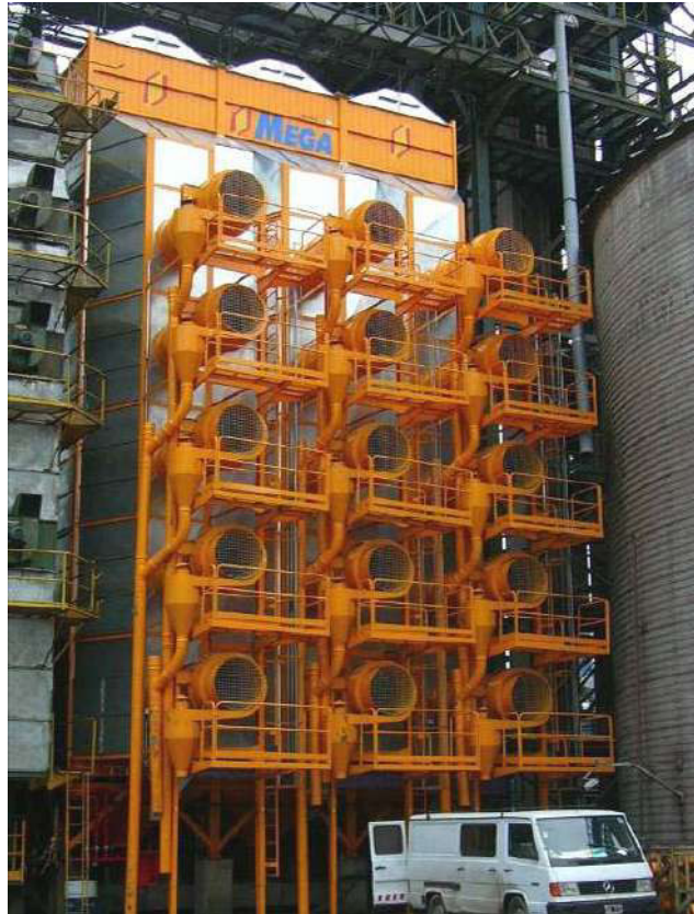
MEGA TC 360 con Separadores de Polvo. MEGA TC 360 with Dust and Fine Collectors.
