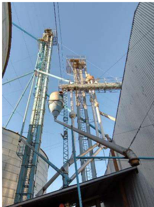
Imagen 17. Vista ciclón de noria Planta 2.
