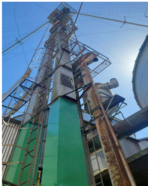
Imagen 19. Noria y sistema de captación de polvos Planta 2.
