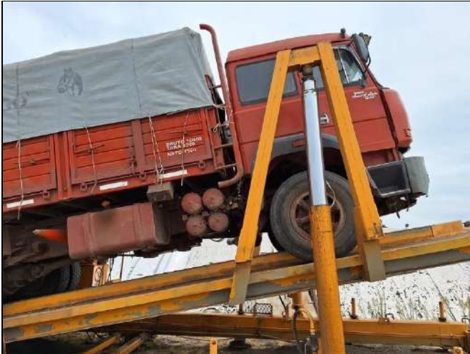
Plataforma de Descarga de Camiones
