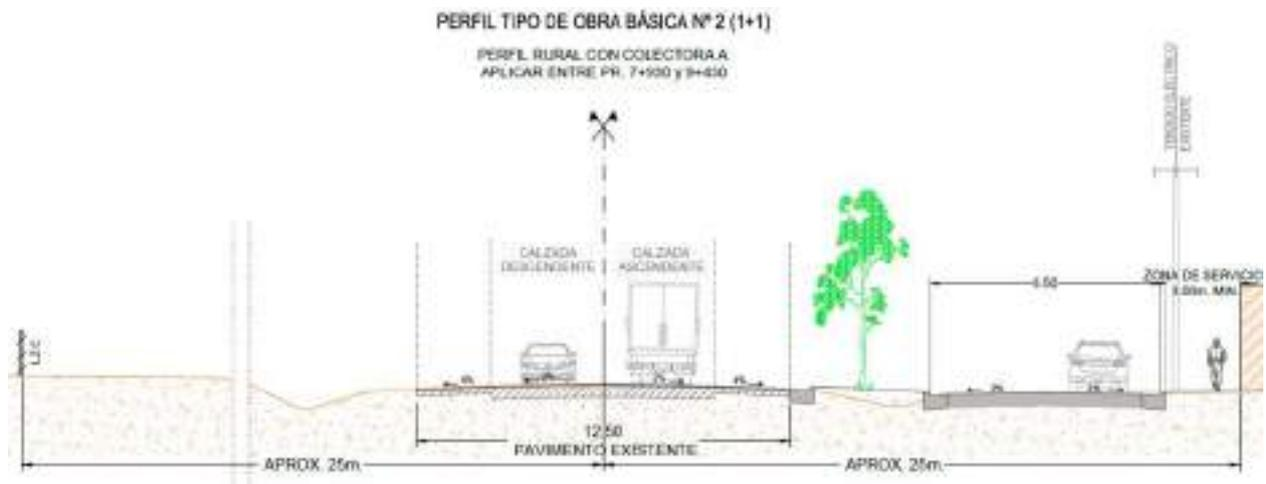
Repavimentación integral y construcción de colectora. A aplicar entre Pr. (7+930) y Pr. (9+430)
