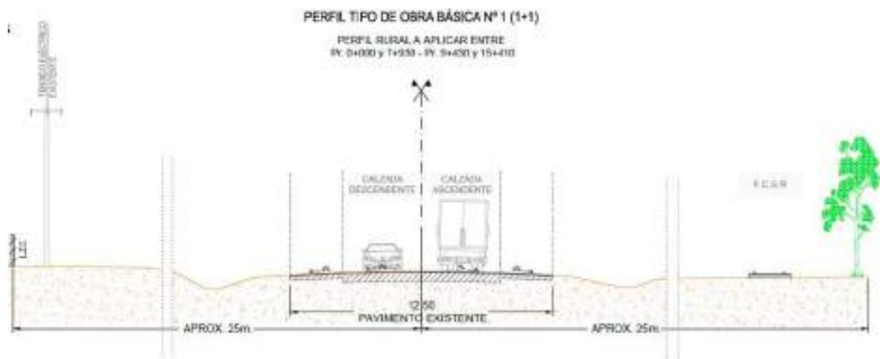
Repavimentación integral. A aplicar entre Pr. (0+000) a Pr. (7+930) y entre Pr. (9+430) a Pr. (15+410)
