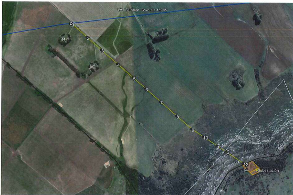
Fig. 8 - Ubicación de los postes de la nueva línea de interconexión
