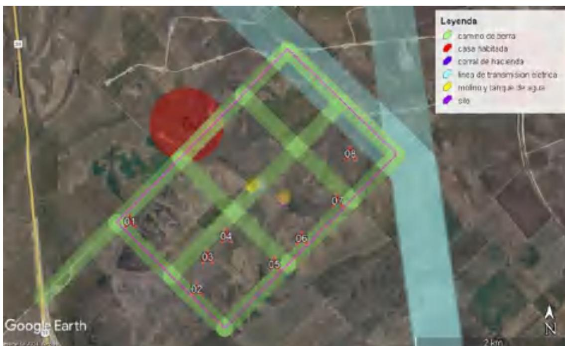
**Imagen 6. Buffers considerados sobre construcciones preexistentes y características naturales del terreno, para la propuesta de emplazamiento de aerogeneradores (layout). Límite de área de proyecto en color rosa.**
