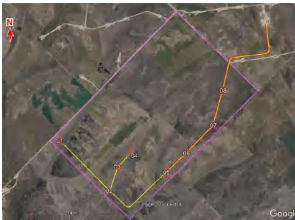
**Imagen 12. Trazo de zanja en terreno para ruteo de circuitos colectores (1 y 2) de media tensión, desde los aerogeneradores hacia ET Tres Picos. Circuito # 1 en color rojo, y circuito # 2 en color amarillo. Límite de área de proyecto en color rosa. Fuente. Energética Argentina S.A.**
