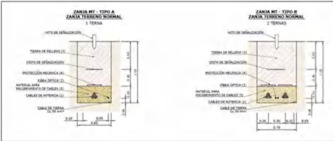
**Figura 8. Corte transversal de sección típica de zanjas para ruteo subterráneo de sistema colector de media tensión. Fuente. Energética Argentina S.A.**
