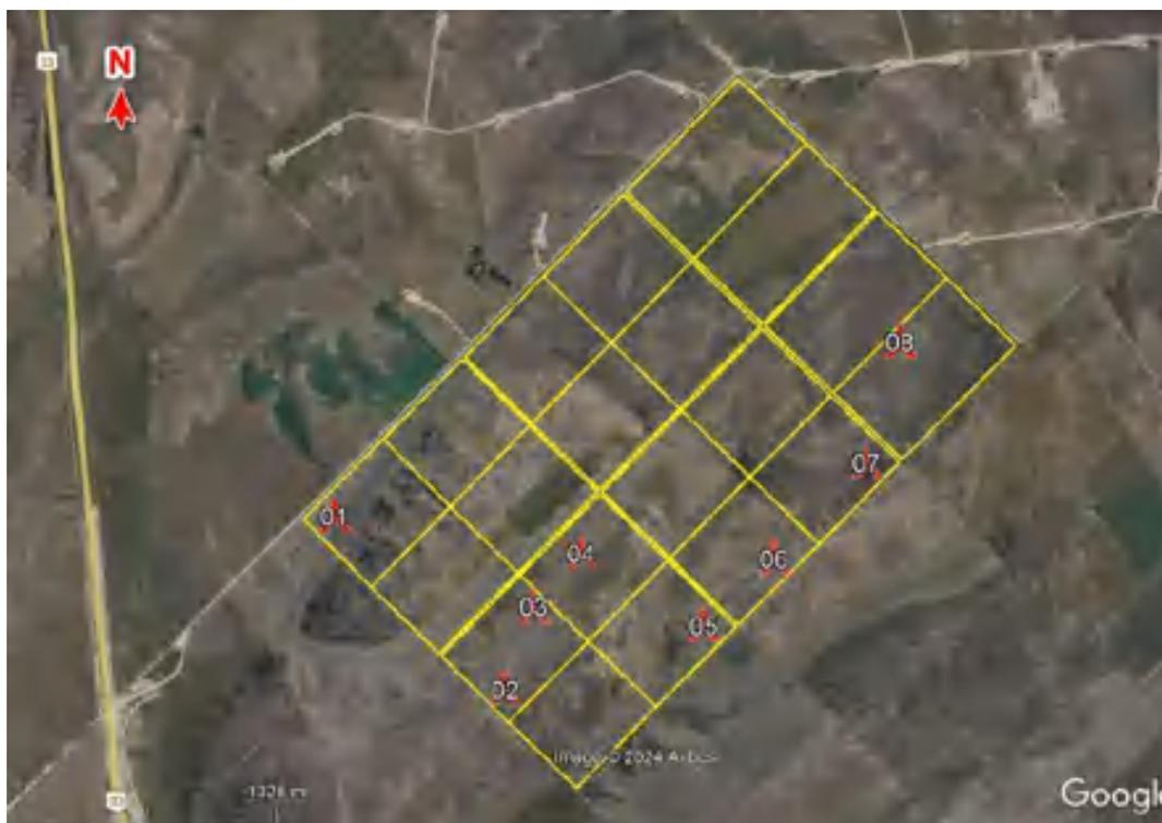
**Imagen 5. Distribución de emplazamiento de aerogeneradores sobre el terreno. Layout. Fuente. Energética Argentina S.A.**
