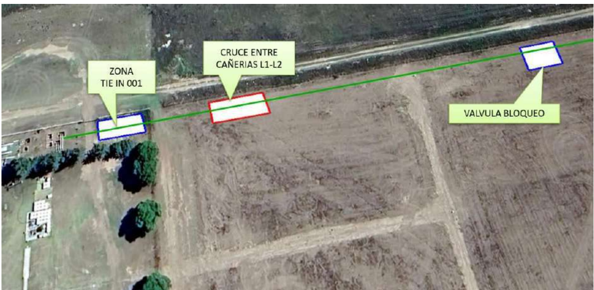
Figura 3.3 Tramo 1 – L1. Vista de zona de cruce de cañerías L1 – L2 y Válvula de bloqueo
