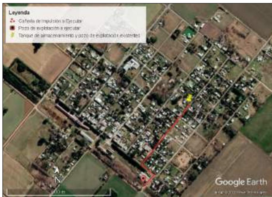
**Figura 4: Ubicación relativa del pozo y la cañería de impulsión a ejecutar. Localidad de Rancagua.**
