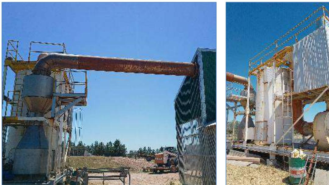
*Figura: Vistas del sistema del sistema de lavado de gases asociado al horno de secado.*
