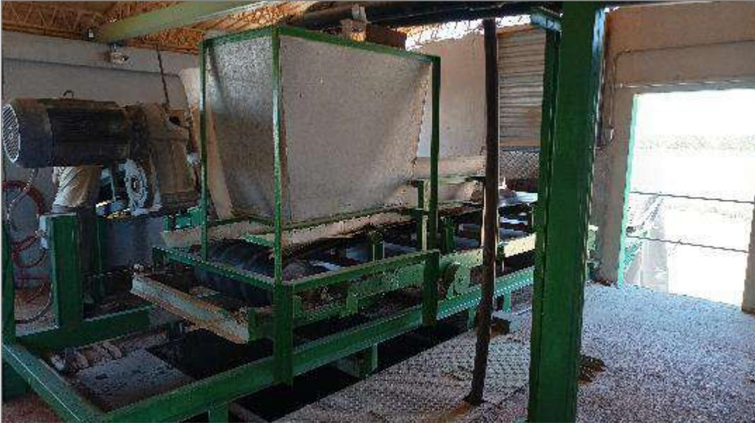
*Figura: Vista del sistema de extracción de conchilla del sustrato.*
