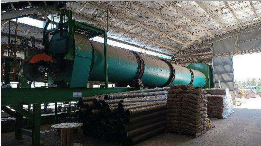
*Figura: Imagen del horno rotativo a ser utilizado para el secado del digestato sólido.*
