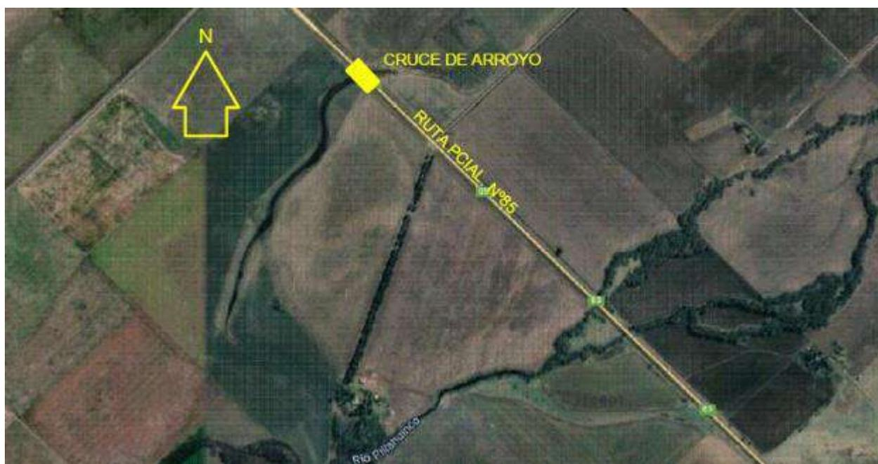
Figura 2.8.Vista de cauce (bajo anegable) en el km 111 de la RP N° 85. El cruce de realizará con tunelera dirigida. Ver ANTEP.03-007088-00-21 - RS-CP-GPSP-PC-CA1-22 - REV 01 - A2
