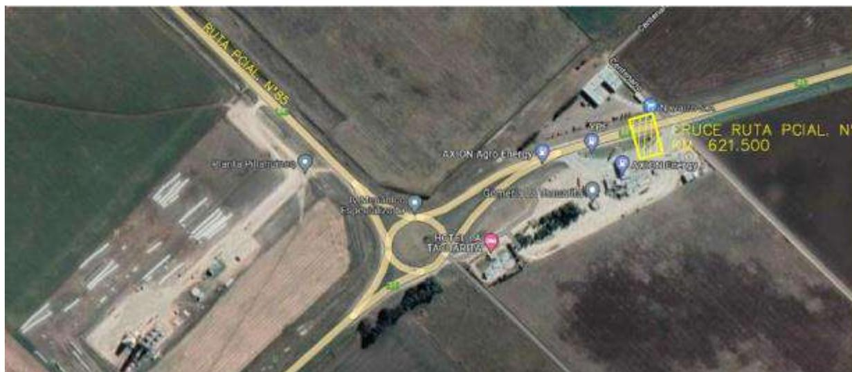
Figura 2.7. Imagen satelital donde se observa el punto de la Ruta Provincial N° 51 en el km 621,500, donde cruzará la nueva cañería hacia la GNC Petropringles S.A. El cruce de la ruta se realizará con tunelera dirigida.
