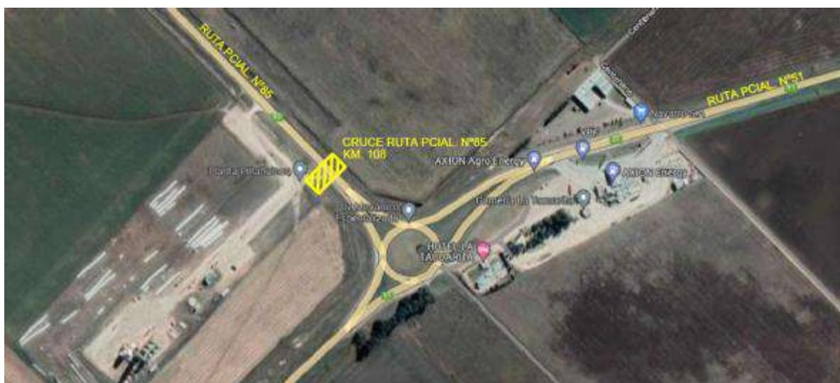
Figura 2.5. Imagen satelital donde se observa el punto de la Ruta Provincial N° 85 en el km 108 donde cruzará la nueva cañería hacia la Planta Pillahuinco. El cruce de la ruta se realizará con tunelera dirigida.
