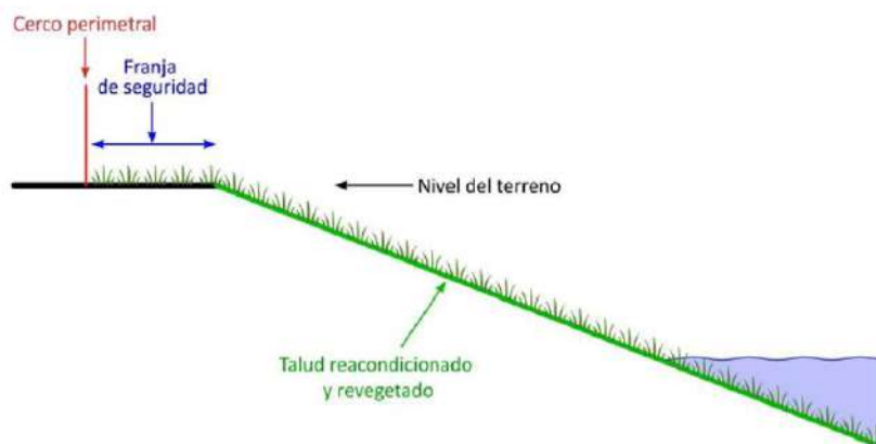
Figura 17. Nivelado, alisado y escarificado de la superficie del talud. Fuente. Luz de Tres Picos S.A.
