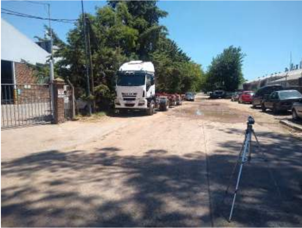
Figura 3.7 – Mediciones de ruido en el entorno industrial.
