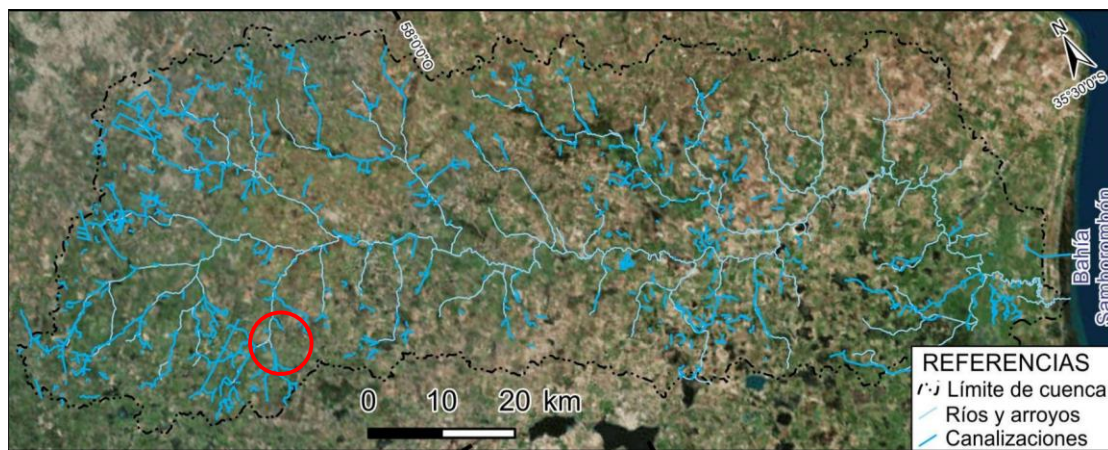
Figura 25: Red de drenaje natural y canalizaciones en la cuenca del río Samborombón.
