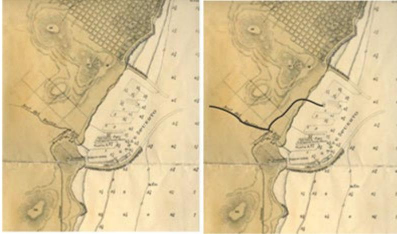
*Fig. 11. Desembocadura original del Arroyo del Barco (previa al cierre del espejo de agua del puerto) y modificada con el entubamiento de 2016.*
