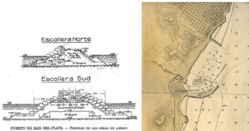
Fig. 2. Perfiles de diseño de las escolleras norte y sur. Evolución de la construcción de ambas escolleras según carta de 1915.
