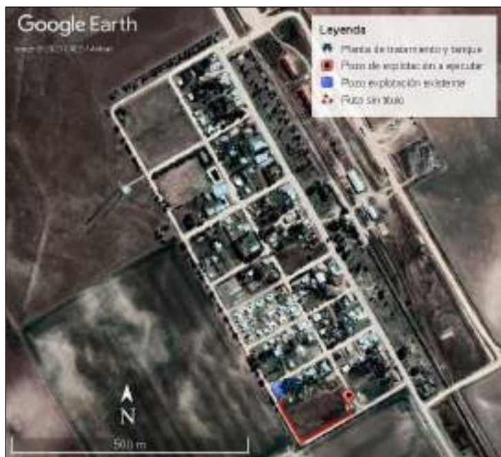
Figura 4: Ubicación relativa de los pozos y cañería de impulsión. Localidad de Chasicó.
