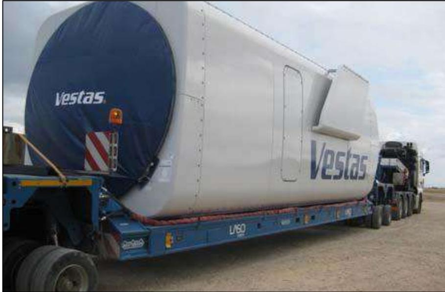
*Figura 1.9. Transporte de Nacelle de aerogenerador.*
