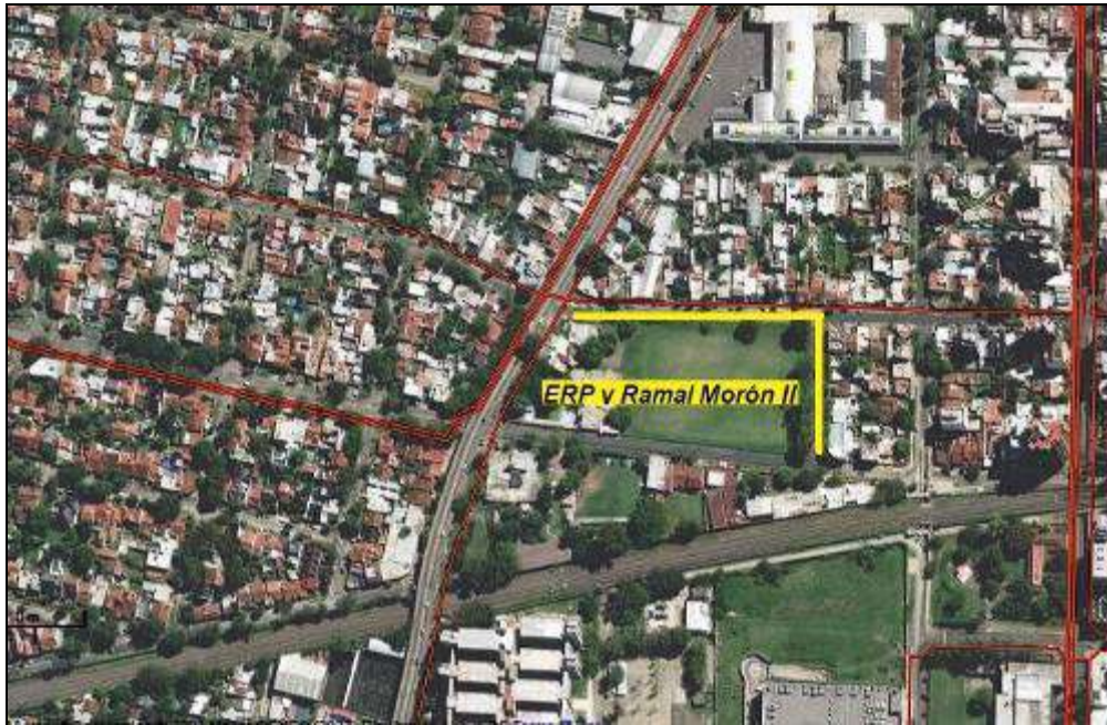
Figura 4.26. Ubicación de cables eléctricos MT sub. (13,2 Kv) en el área de estudio. Fuente: Información Geográfica / Energía. Secretaría de Energía de la Nación. https://sig.se.gob.ar/visor/visorsig.php?t=1
