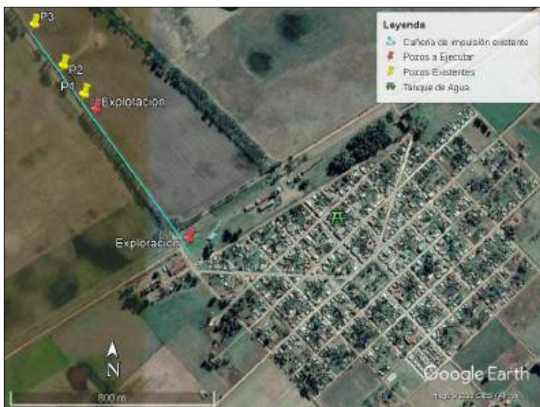
Figura 4: Ubicación relativa de los pozos y cañería de impulsión. Localidad de Pirovano.
