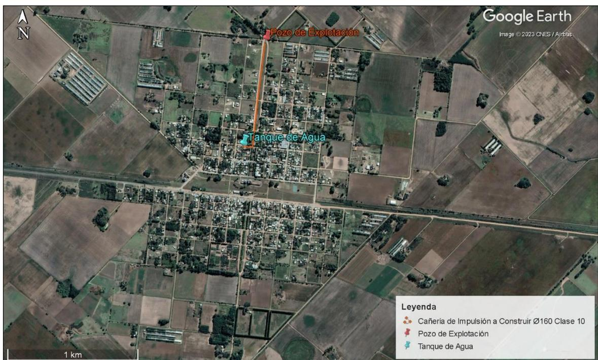
**Figura 4: Ubicación del pozo y cañería a ejecutar respecto el Tanque. Pedernales.**
