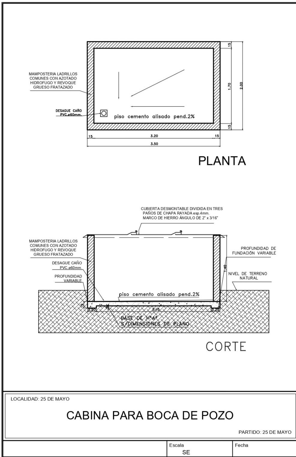
Figura 4: Esquema de cabina para boca de pozo.
