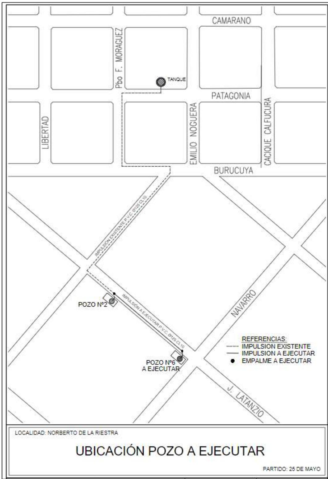
**Figura 1: Ubicación de la perforación de explotación**
