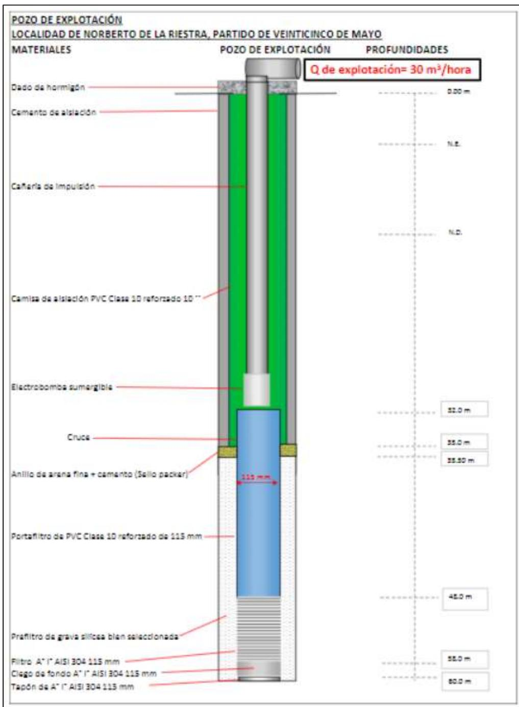
**Figura 3: Esquema del pozo de explotación**
