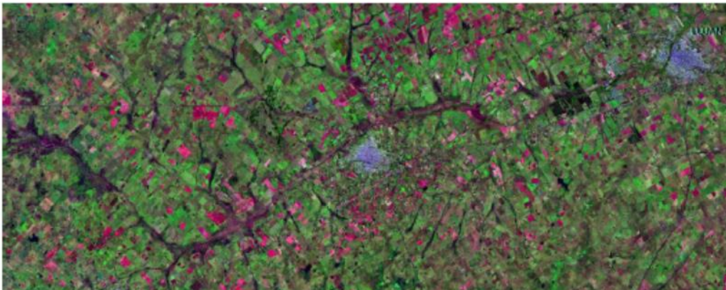
Figura 21: Sección Superior del río Luján, entre su cabecera y la ciudad homónima. El color morado que acompaña el recorrido del cauce corresponde a la faja de la llanura de inundación. Fuente: TECHNIPLAN – BETA STUDIO – DEMISON CONSULTORA, 2018
