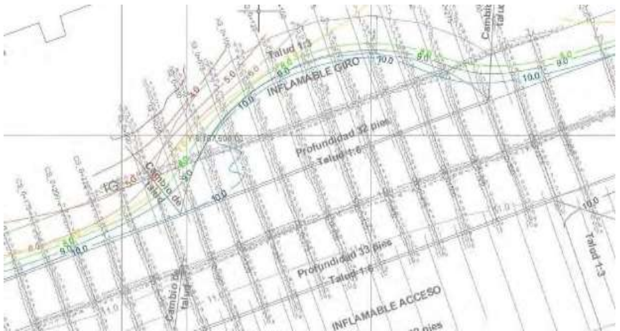
Figura 6. Batimetría de zona de maniobras frente a Muelle A-A'
