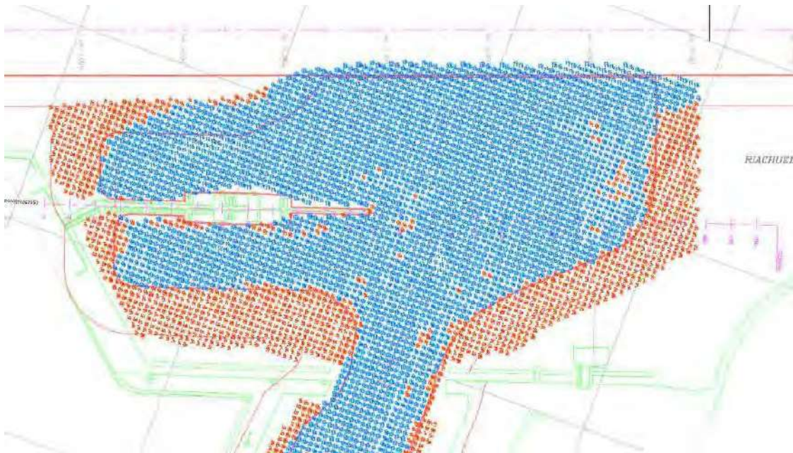
Figura 5. Batimetría zona Muelle A-A' y acceso a Dársena de Inflamables
