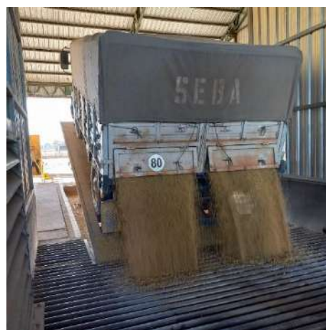
Descarga de camión a rejilla
