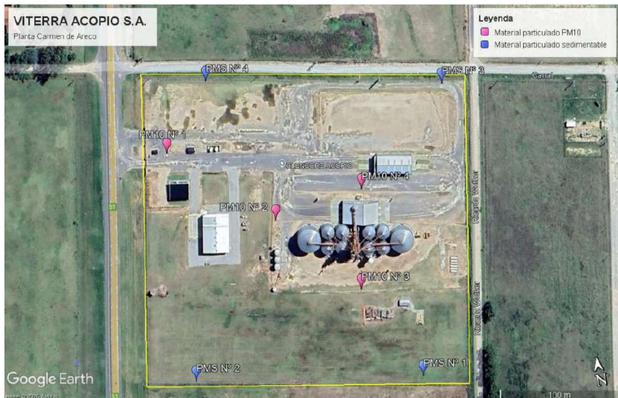
Croquis de ubicación de puntos de medición de PM10 y PM sedimentable
