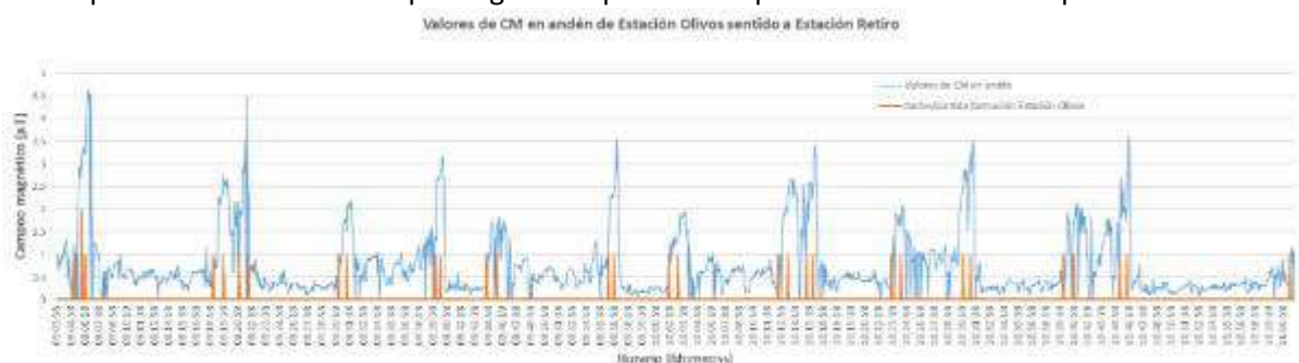
ILUSTRACIÓN 51 REPRESENTACIÓN DE LOS VALORES DE CM MEDIDOS JUNTO AL ANDÉN (TRAZO AZUL) Y LOS MOMENTOS DE ARRIBO / SALIDA DE FORMACIONES EN LA ESTACIÓN OLIVOS (TRAZO NARANJA). FUENTE: INFORME ITREE-LAT IL-041-23 - (2023)
