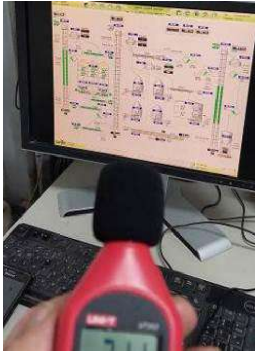
Imagen 1. Medición de ruido laboral
