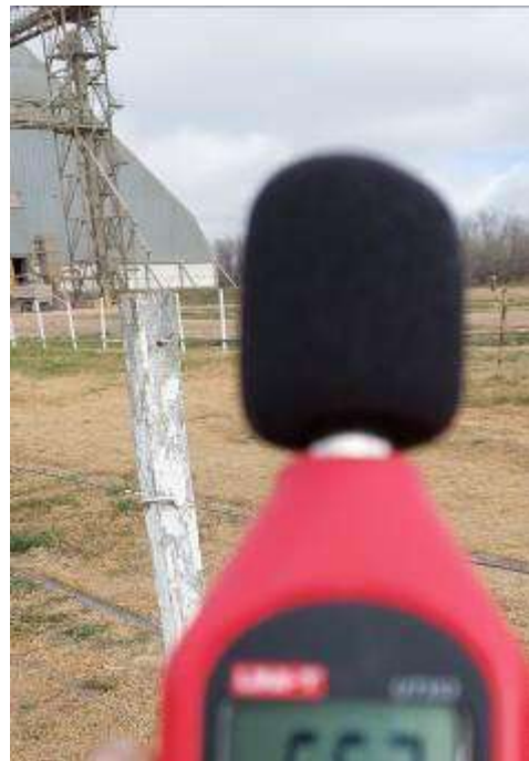
Imagen 4. Medición de ruido ambiental
