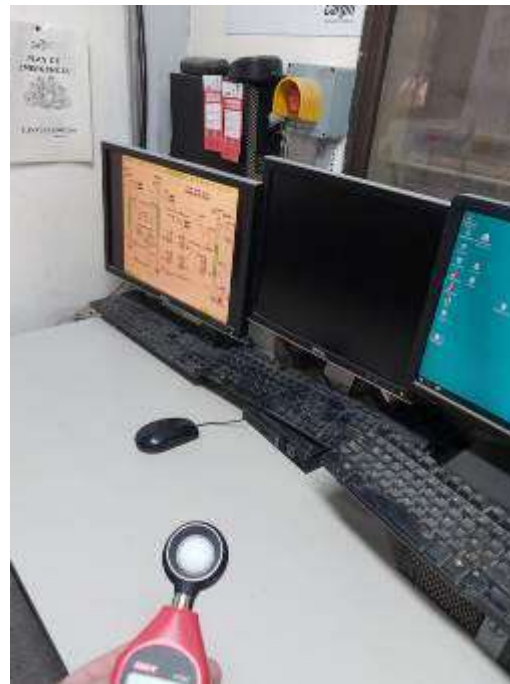
Imagen 2. Medición de iluminación
