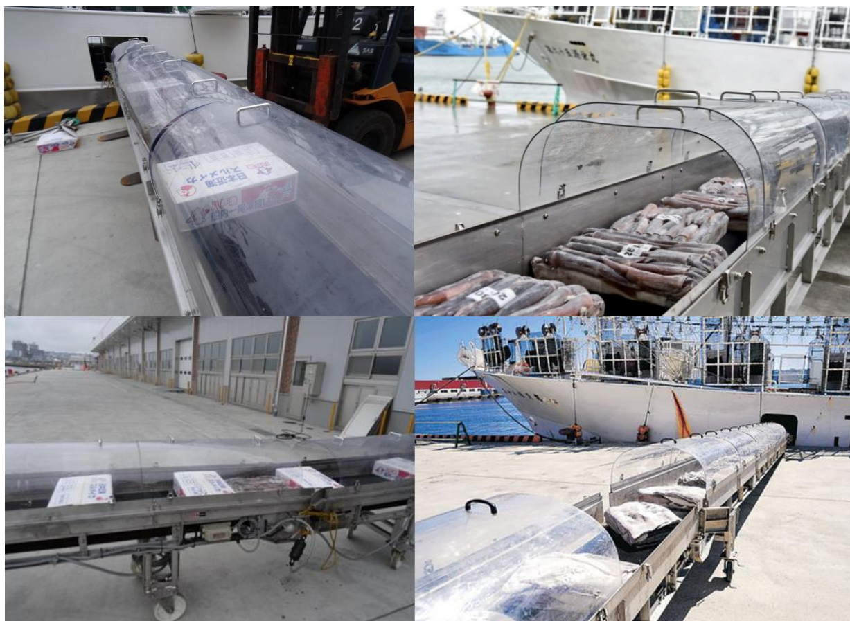
Figura 15: Fotografías ejemplo del sistema de cintas automatizadas para descarga de pastillas congeladoras de buques.
